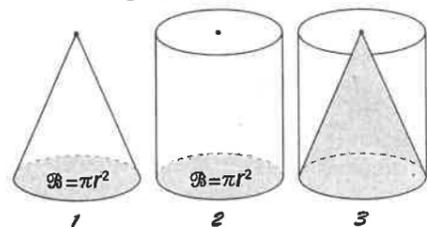
À l'aide d'une éprouvette graduée, on mesure le volume d'eau nécessaire pour remplir la partie de l'espace comprise entre le cône et le cylindre. La mesure donne les  $\frac{2}{3}$  du volume du cylindre.
