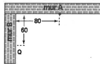
Il mesure PQ. Quelle distance doit-il trouver pour être certain que les murs A et B forment bien un angle droit ?
