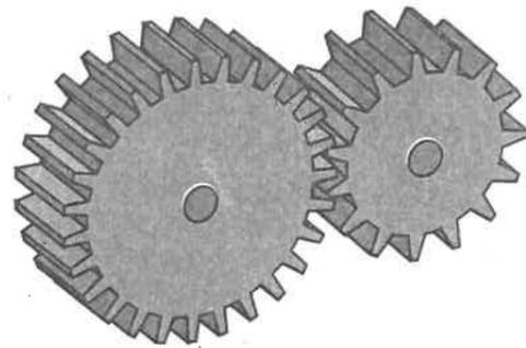
Le premier engrenage a une roue d'entraînement de 27 dents et l'autre roue (soumise au mouvement de la première) a 15 dents.
